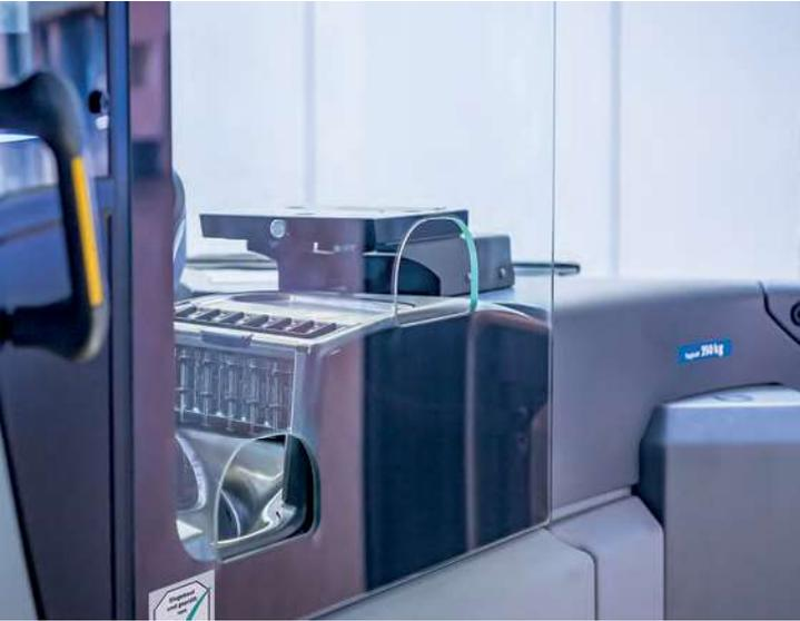
Der Virenschutz für Fahrer ist schnell zu montieren und ist eine im Rahmen der Fahrzeugtypgenehmigung genehmigte wahlweise Ausrüstung. (Eine KBA-Bestätigung entsprechend einer allgemeinen Betriebserlaubnis ABE liegt vor.) Damit entfällt eine Einzelabnahme beim TÜV (oder bei anderen Prüfinstituten).
